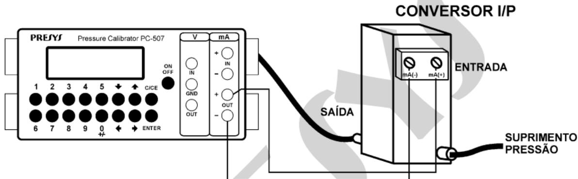
**Fig. 18** – Calibração de Conversores I/P
