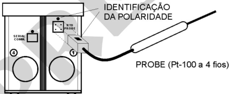
Fig. 05 – Conexão do Probe
