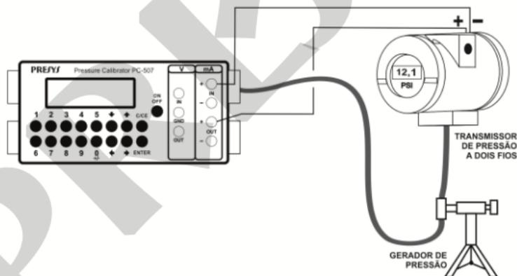
**Fig. 14** – Calibração de Transmissores de Pressão a 2 Fios
