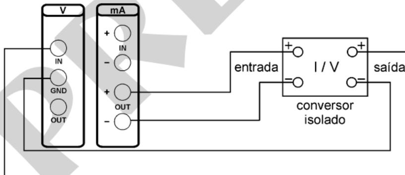
**Fig. 13** – Conversor I/V (Isolado)
