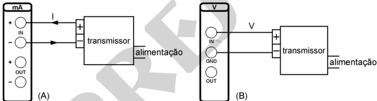
**Fig. 09** – Calibração de Transmissores a 4 Fios
