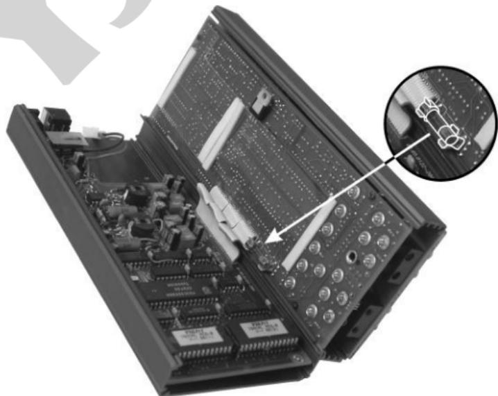
**Fig. 19** - Substituição do fusível da entrada em corrente
