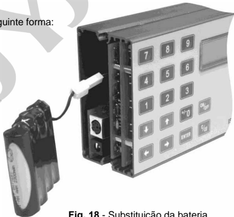
Fig. 18 - Substituição da bateria
